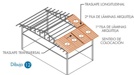
3. Para la instalación de la lámina 2 en su traslape transversal se recomienda sostener con tenazas de presión con la lámina 1 en los extremos, para mantener la alineación (ver Dibujo 13).
